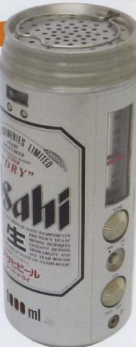
ASAHIビールのノベルティラジオ。ある方向から見ると、「スーパー・ドライ」のロゴ缶そのものだ。ラジオとしてのメカがしっかりしており、周波数表示も糸掛け式の横行きダイヤル、LEDのチューニング・インジケーターも装備されている。デジタル時計も内蔵されており実用性は非常に高い。
