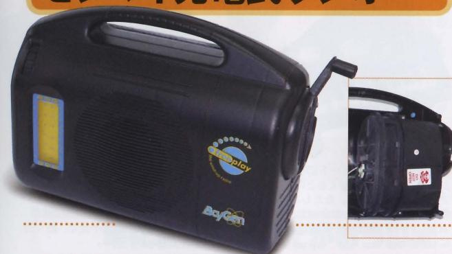
手回し発電機付きラジオは珍しくないが、いずれも発生させた電気を、一旦充電池に貯め回路を駆動する。本ラジオは巻かれたゼンマイが元に戻る力をを利用して発電機を回す珍しい仕掛けだ。この機構はイギリス人の発明家 Trevor Baylis が発明したもの。60回巻くと約30分間ラジオが聴けるが、かなり疲れる作業ではある。ラジオの筐体は大きめで、その大半は内蔵の大容量ゼンマイボックスによるものだ(写真参照)。
